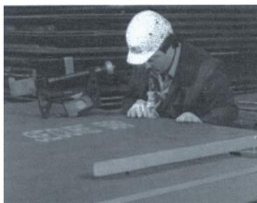
在場內做最後檢查板的厚度、硬度與平坦度試驗
