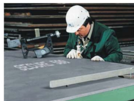
在場內做最後檢查板的厚度、硬度與平坦度試驗
